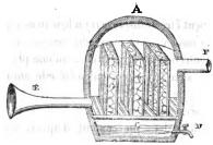
Ce ventilateur se place dans une cour ou une antichambre; le conduit F, dit de départ, débouche seul dans la pièce du malade, en traversant le mur ou une cloison.
