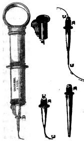
séparer pour les nettoyer plus facilement ; puis il suffit de monter au moyen du frottement de fil ciré BB les tubes capillaires CC sur la vis A, ainsi que le représente la fig. D, pour rendre l'instrument apte à fonctionner de nouveau.
