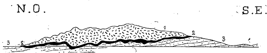
Coupe à travers le bloc (ou le lambeau de nappe , ou la Klippe ) de la Liquière, au sud-sud-est de Salindres, suivant la tranche d'un embranchement abandonné de chemin de fer. — 1, mylonite de calcaire urgonien, très rocheuse et simulant le calcaire homogène; 2, zone de mélange mécanique, débris de mylonite enrobés dans les argiles tongriennes; 3, Tongrien, argiles bariolées, grès, calcaires tendres, poudingues à petits galets polygéniques. — La ligne horizontale correspond au fond de la tranchée. Échelle approximative \frac{1}{5000} .
